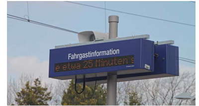
Das Streitobjekt: der Dynamische Schriftanzeiger (DSA) mit integrierter Beschallungseinrichtung für Verspätungsanzeigen und -ansagen. (Foto: BfVst)
