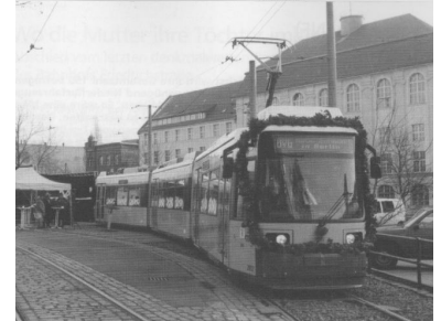
Niederflur-Straßenbahn: Zweirichtungs-Variante. (Foto: Marc Heller)
