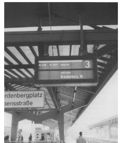
Zwei mal Bahnhof Zoo, zwei mal die gleiche Entfernung des Fotografen von der Anzeige. Die alte Fallblattanzeige ist bedeutend besser lesbar als die neue elektronische Matrixanzeige. Eine ständige Anzeigemöglichkeit für verspätete Züge ist leider nicht vorgesehen. (Foto: Alexander Frenzel)
