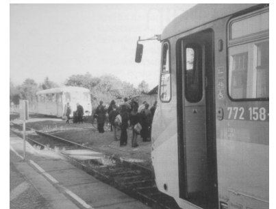
Zugbegegnung in Arendsee. An den älteren Triebwagen der Baureihe 772, auch liebevoll Ferkeltaxen genannt, sind noch Spiegel für den Lokführer vorhanden. Ohne weitere Technik kann er wirkungsvoll die Türen beobachten. (Foto: Ingo Franßen)
