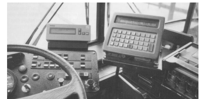
Modernste Technik, satellitengesteuert, rechnerprogrammiert. Aber in der Praxis ist die Technik, auf die man setzt, nicht so verlässlich. (Foto: RBL-Gerät und Fahrkartendrucker im Bus, Alexander Frenzel)
