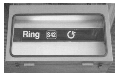
Auch alte Pragotron-Anzeiger lassen sich auf die Ringbahn einstellen. Die Drehrichtung des Pfeiles gibt die Fahrrichtung des Zuges auf dem Ring wieder. Die Liniennummer macht die Angabe eindeutig. (Foto: Florian Müller)
