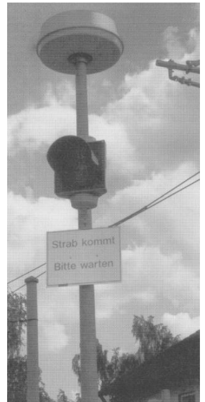
In anderen Städten, wie hier in Freiburg, ist eine Anschlusssicherung zwischen Straßenbahn und Bus auch mit einfachen technischen Lösungen selbstverständlich. In Berlin gibt es zwar technisch sehr aufwändige Betriebsleitsysteme, aber eine Anschlusssicherung zwischen Straßenbahn und Bus ist nicht möglich: Die Fahrgäste, die ab Dezember zwischen Straßenbahn-Linie 52 und Buslinie 107 umsteigen müssen, werden dies bitter zu spüren bekommen. (Foto: Matthias Horth)
