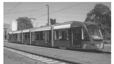
Das erste in Potsdam getestete Fahrzeug war eine Variobahn der Firma Stadler Pankow. Dabei handelt es sich um einen Prototyp, der seit 1996 von den Verkehrsbetrieben in Duisburg eingesetzt wird. Straßenbahnen dieser Fahrzeugfamilie sind bereits bei verschiedenen Verkehrsbetrieben im Einsatz, z. B. in Chemnitz. (Foto: Wilfried Ruppert, Mai 2005)
