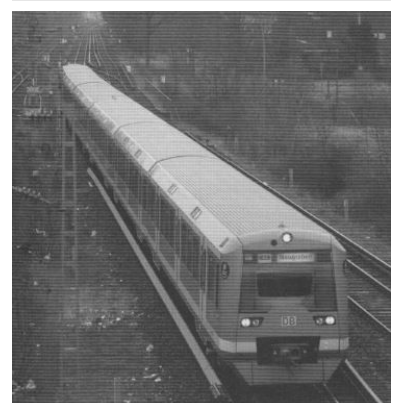
Ein ET 474 der S 3 aus Richtung Hamburg-Harburg nähert sich der heutigen Endstation Hamburg-Neugraben. Im Bereich des Geisvorfeldes soll künftig der automatische Systemwechsel vom seitlich abgenommenen Gleichstrom zum Oberleitungs-Wechselstrom erfolgen. (Foto: Michael Hertel)
