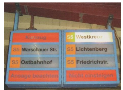
Seit Jahrzehnten bewährt. Leuchtkästen, auch Transparentzugzielanzeiger genannt, sind mit Glühlampentechnik offenbar zu einfach für eine moderne Bahn AG. Da sie nicht computerkompatibel sind, sollen sie durch Blechschilder ersetzt werden. (Foto: Florian Müller)
