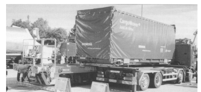
Vom Lkw auf den Güterwagen und umgekehrt. Die Umschlagtechnik »Mobiler« macht es möglich (Foto: Christian Schultz)
