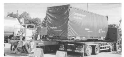
Vom Lkw auf den Güterwagen und umgekehrt. Die Umschlagtechnik »Mobiler« macht es möglich (Foto: Christian Schultz)
