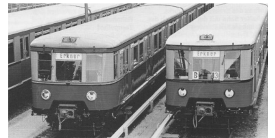
Die Museumsviertelzüge 3839/6401 (im Anlieferungszustand von 1938) und ET/EB 167 072 (nach der Rekonstruktion 1963), vorn die Triebwagen mit ihren runden und gefälligen Stimpfarten (Foto: Walied Lorenz)
