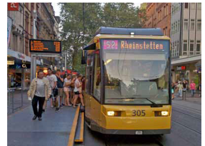
In Karlsruhe wurden bisher Rollbänder mit farbigen Liniensignets verwendet. Bei Neubeschaffungen hat man selbstverständlich LED-Anzeiger gewählt, die ebenfalls farbige Liniensignets darstellen können. (Foto: PW Stadt ohne Barrieren)
