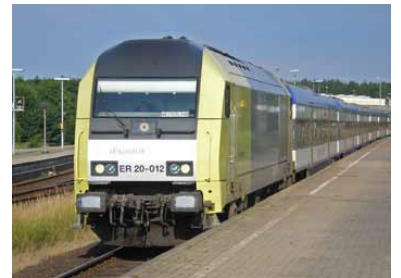
Bahnhof Husum in Schleswig-Holstein. Die lediglich bis Itzehoe erfolgte Elektrifizierung der Marschbahn ist Ursache dafür, dass auf der insgesamt 238 km langen Strecke zwischen Hamburg-Altona und Westerland (Sylt) u. a. die Züge der Nord-Ostsee-Bahn mit Dieseltraktion fahren müssen. (Foto: Christian Schultz)
