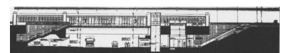
Längsschnitt durch den neuen Bahnhof Baumschulenweg. Zugänge von beiden Straßenseiten, Fahrtreppen und Aufzüge werden das Umsteigen bequemer machen. (Plan: DB Projektbau)
