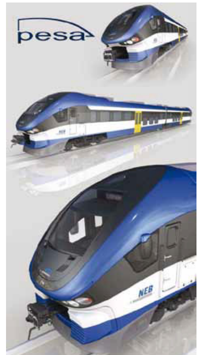
Die NEB hat bei Pesa 9 LINK-Dieseltriebzüge bestellt, davon o 7 Züge mit 2 Wagen, 140 Sitzplätze, 12 (+6) Fahrradstellplätze und o 2 Züge mit 3 Wagen, 200 Sitzplätze, 24 (+6) Fahrradstellplätze, generell für Höchstgeschwindigkeit 140 km/h, polnische und deutsche Zulassung für die Direktverbindung Berlin--Kostrzyn--Gorzów, Lieferung zur Betriebsaufnahme Dezember 2015. (Abb.: NEB/Pesa)
