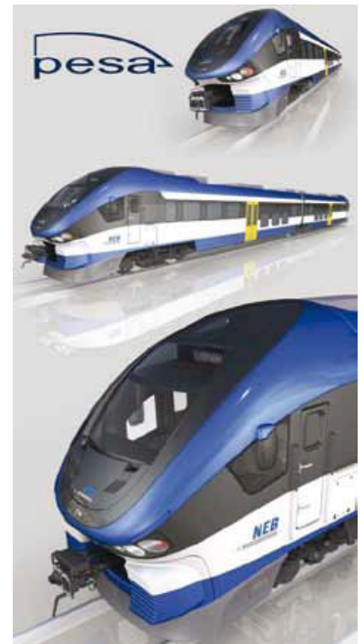
Die NEB hat bei Pesa 9 LINK-Dieseltriebzüge bestellt, davon o 7 Züge mit 2 Wagen, 140 Sitzplätze, 12 (+6) Fahrradstellplätze und o 2 Züge mit 3 Wagen, 200 Sitzplätze, 24 (+6) Fahrradstellplätze, generell für Höchstgeschwindigkeit 140 km/h, polnische und deutsche Zulassung für die Direktverbindung Berlin--Kostrzyn--Gorzów, Lieferung zur Betriebsaufnahme Dezember 2015. (Abb.: NEB/Pesa)
