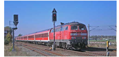
Diesel-IC auf der Stammstrecke am Bahnhof Schönhausen (Elbe). Da Schotter-Oberbau einfacher zu reparieren ist als die Feste Fahrbahn der Hochgeschwindigkeitsstrecke (im Hintergrund), konnte die Stammstrecke zwei Monate früher freigegeben werden. (Foto: Christian Schultz)
