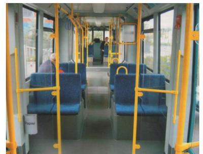
Bombardier liefert mit seinen Flexity-Classic-Fahrzeugen für Frankfurt am Main den Beweis, dass Drehgestelle und Niederflertechnik kein Widerspruch sein müssen. Unter den Radkästen befindet sich ein Laufdrehgestell mit gekröpften Achsen und Losrädern. Der Hochflurbereich im Hintergrund ist durch nur eine Stufe einfach zu erreichen. (Foto: Florian Müller)
