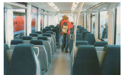
Mit dem Regio-Citadis von Alstom-LHB eifert man in Kassel dem Karlsruher Modell nach. Zur Verknüpfung von Straßenbahn und Eisenbahn ist das Fahrzeug für zwei Stromsysteme tauglich. Außerdem wird es noch eine Hybrid-Variante mit Dieselantrieb geben. Der Mittelwagen (Bild) dient den Langstreckenfahrern und hat deshalb Gepäckablagen, aber keine Türen. Im Niederflurbereich der Endwagen befinden sich die Türen und Stellflächen. (Foto: Florian Müller)
