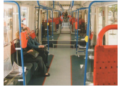
Die Firma PESA in Bydgoszcz (Bromberg) baut für die Warschauer Vorortbahn WKD den vierteiligen Niederflurgelenktriebwagen Typ EN 95. Der Fahrgastraum wirkt großzügig und aufgeräumt, die Gelenkbereiche verschwinden geschickt hinter den Sitzlehnen. Die Fußbodenmarkierung ist auch als Orientierungshilfe für sehgeschwache Fahrgäste nützlich (Foto: Florian Müller)
