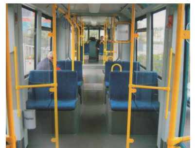
Bombardier liefert mit seinen Flexity-Classic-Fahrzeugen für Frankfurt am Main den Beweis, dass Drehgestelle und Niederflertechnik kein Widerspruch sein müssen. Unter den Radkästen befindet sich ein Laufdrehgestell mit gekröpften Achsen und Losrädern. Der Hochflurbereich im Hintergrund ist durch nur eine Stufe einfach zu erreichen. (Foto: Florian Müller)
