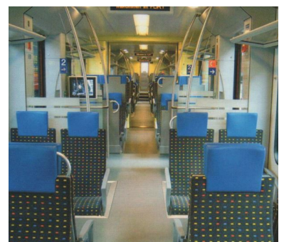
In Berlin-Wilhelmsruh wird der niederflurige Elektro-Triebwagen »FLIRT« für den Schweizer Regionalverkehr gebaut. Als einziges ausgestelltes Fahrzeug besitzt es Rampen statt Stufen an den Wagenübergängen. Beachtenswert ist die komfortable Innenausstattung der zweiten Klasse: Verkehrsbesteller in der Schweiz halten offenbar Armelehnen und Kopfstützen auch im Nahverkehr für unentbehrlich. (Foto: Florian Müller)
