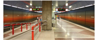
Duisburg Hbf: Links der abgesenkte Bahnsteig für die teilmittelflurigen Straßenbahnen, rechts für die hochflurigen Stadtbahnen. Am anderen Bahnsteigende ist es umgedreht. Eine Etage höher sieht es genauso aus. Vier Gleise für drei Linien - teure Infrastruktur, die es instandzuhalten gilt. (Foto: A. Savin)
