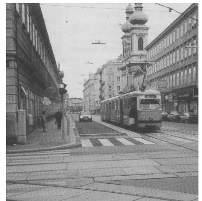
Vorbild Wien. Da eine Haltestelleninsel für die Tramfahrgäste hier jeweils nicht möglich war, wurde die Autofahrbahn im Haltestellenbereich erhöht und deutlich markiert. So konnte auch ohne Haltestelleninsel die beim Ein- und Ausstieg in die Tram zu überwindende Höhe reduziert werden. Aber in Berlin sind solche fahrgastfreundlichen Lösungen derzeit natürlich nicht möglich, weil sie nicht mit den auto-orientierten Planungszielen der Verkehrspolitik Schmitt und Haase vereinbar sind. (Foto: Gabriela Seebacher)
