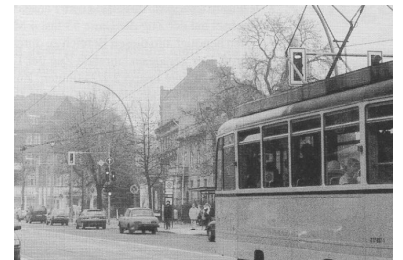
Bild 1 - Ein Zug der Tramlinie 53 steht vor dem durch eine zusätzliche Ampel abgesicherten Haltestellenbereich in der Grabbeallee/Pastor-Niemöller-Platz. Während das Tram-Signal rot zeigt, hat der Autoverkehr grün. (Foto: I. Schmidt)
