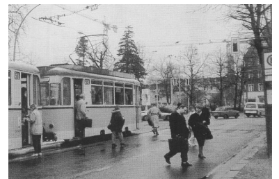
Bild 2 - Die Tram durfte in den Haltestellenbereich einfahren. Jetzt zeigt die vor dem Haltestellenbereich liegende Ampel für den Autoverkehr kurz rot, so daß die Fahrgäste gefahrlos aus- und einsteigen können. (Foto: I. Schmidt)
