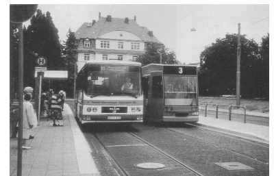
Gemeinsame Trasse und Haltestelle von (Niederflur-)Tram und Bus - auch hierbei ist Kassel ein Vorbild für Berlin. (Foto: Matthias Horth)
