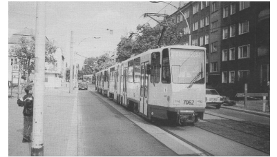
Modernisierter Tatra-Zug. Die modernisierten und die Neubau-Fahrzeuge sollen ab 1995 nur noch bei Bedarf halten. Auch bei "Altbaufahrzeugen" ohne Haltewunschtaaste ist die Einführung des Bedarfshaltes vorgesehen, wenn sie als Solowagen verkehren und der Fahrer den Innenraum per Spiegel überschauen kann. (Foto: Frank Brunner)
