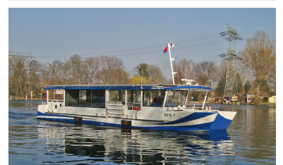
In Treptow-Köpenick verkehren vier bauähnliche kleinere Katamaran-Fähre mit Solarstrom, die 35 bis 49 Fahrgäste befördern können, hier die F 11. (Foto: Florian Müller)
