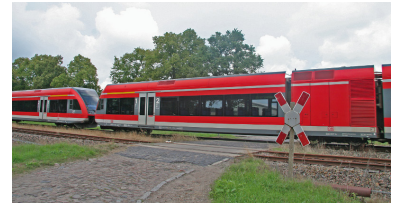
Technisch ungesicherte Übergänge zwingen die Züge oft zum Abbremsen, wie hier bei Rheinsberg. (Foto: BfVs)
