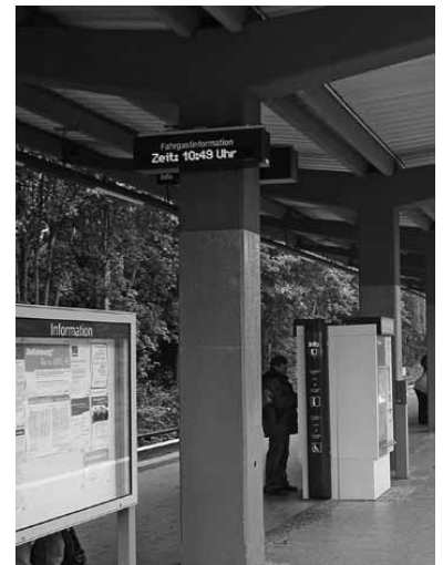
S-Bahnhof Borgsdorf: Ein dynamisches Fahrgastinformationssystem auf dem Bahnsteig, das Angaben über Zugverspätungen zeigen kann. Bei planmäßigem Betrieb wird die Uhrzeit angezeigt. Andere dynamische Fahrgastinfos wie Zugzielanzeiger sind hier leider nicht vorhanden, sollten aber auf allen S-Bahnhöfen Standard sein. (Foto: Florian Müller)
