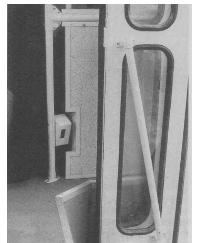
Besser als bei den modernisierten Fahrzeugen der BVG ist in Schöneiche die Türraumüberwachung, da auch Fahrgäste auf den Stufen erfaßt werden. (Foto: Ivo Köhler)
