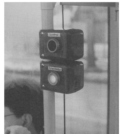
Während die erste und dritte Tür nach dem Fahrgastwechsel selbsttätig schließen, bleiben die zweite und vierte zum Einstieg mit Gepäck und Kinderwagen geöffnet, können aber mittels Druckknopf von den Fahrgästen geschlossen werden. Somit gibt es im VBB-Bereich leider eine weitere Sonderregelung. (Foto: Ivo Köhler)
