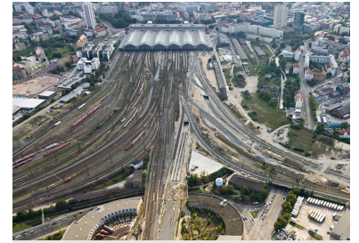
Leipzig Hauptbahnhof. Rechts sind die beiden Tunnelmündungen im Bau zu erkennen. Die Tunnelstation befindet sich unter der Halle rechts. (Foto: Christoph Busse, DB AG)
