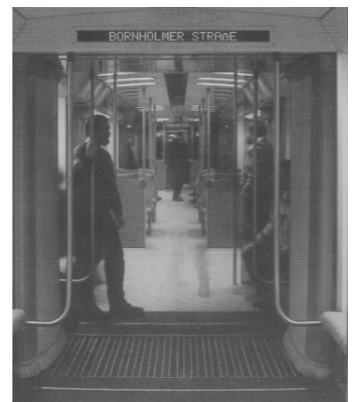
Zwischen den beiden Wagen eines Viertelzuges besteht ein begehrbarer Übergang. Die S-Bahn-Berlin GmbH überlegt, künftig sogar den Halbzug mit vier durchgehend begehrbaren Wagen als kleinste Einheit zu bestellen. (Foto: Marc Heller)
