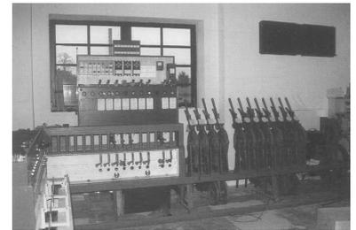
Eines der größten Objekte aus der Sammlung: An diesem mechanischen Stellwerk wurden bis 1995 noch Eisenbahnerausgebildet. Nach der Wiederherstellung der Funktionsfähigkeit sollen an ihm die technischen Bedingungen des Signal- und Sicherungswesens erläutert werden. (Foto: U. Dittfurth)
