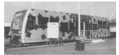
Neuer DWA-Schienenbus auf der InnoTrans, preiswert und mit niedrigem Einsteig, aber mit nur einer Tür und - wie die anderen neuen Nahverkehrstriebwagen auch - ohne WC. (Foto: Thomas Billik (10/96))
