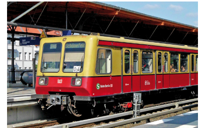
Die Berliner S-Bahn-Züge der Baureihen 480, Baujahre 1990-1994 (links), und 485, Baujahre 1989-1992 (rechts), sollten eigentlich bis Ende 2017 ausgemustert werden, da sie nicht auf die neue S-Bahn-Signaltechnik ZBS umgerüstet werden können. Durch die Verzögerung bei der Ausschreibung der S-Bahn-Leistungen müssen sie nun für den Einsatz bis 2023 für voraussichtlich über 100 Mio Euro ertüchtigt werden. (Foto: Frank Lammers)
