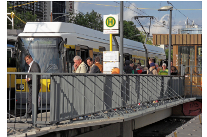
Die provisorische Straßenbahnhaltestelle am S-Bahnhof Landesberger Allee ist zu kurz und verhindert so den Einsatz langer Züge. (Foto: Tom Gerlich)
