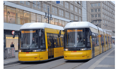
Auf der M 2 verkehren nur 30 m lange Straßenbahnen vom Typ Flexity. Das steigende Fahrgastaufkommen erfordert jedoch den Einsatz von 40 m langen Zügen. (Foto: Marc Heller)
