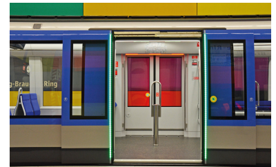
Im neuen U-Bahn-Zug für München der Firma Siemens sind Leuchtbänder an den Türkanten angebracht. Diese leuchten grün, wenn die Türen freigegeben sind und rot, sobald die Türfreigabe zurückgezogen wird. Damit soll die Erkennbarkeit des Öffnungs- und Schließvorgangs verbessert werden. Eine beispielhafte Idee. (Foto: SWM/MVG)
