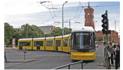
BVG-Straßenbahn Flexity. Von diesen 40 m langen Zweirichtungsfahrzeugen hat die BVG 48 bestellt, von denen aktuell 23 ausgeliefert sind. Die anderen 25 sollen 2015/2016 folgen. Insgesamt hat die BVG bisher 142 Flexity-Straßenbahnen bestellt, der Rahmenvertrag sieht sogar 206 vor. Doch derzeit tendiert die BVG eher zur Entwicklung der nächsten Fahrzeuggeneration als zum Ausschöpfen des Rahmenvertrages. (Foto: Angelo Januschew)
