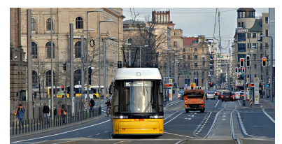
Blick Richtung Nordbahnhof: Im Vordergrund endet der eigene Gleiskörper. Zur Anbindung der Haltestelle Invalidenpark erfolgen 3 Spurwechsel in kurzer Folge (2x rechts, 1x links), die normalerweise durch Ampeln abgesichert werden. Die unübersichtliche Verkehrsführung erfordert höchste Konzentration! Ein eigener Gleiskörper stand hier dem Dogma der durchgehenden Vierspurigkeit für den Autoverkehr entgegen. (Foto: Marc Heller)
