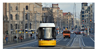
Blick Richtung Nordbahnhof: Im Vordergrund endet der eigene Gleiskörper. Zur Anbindung der Haltestelle Invalidenpark erfolgen 3 Spurwechsel in kurzer Folge (2x rechts, 1x links), die normalerweise durch Ampeln abgesichert werden. Die unübersichtliche Verkehrsführung erfordert höchste Konzentration! Ein eigener Gleiskörper stand hier dem Dogma der durchgehenden Vierspürigkeit für den Autoverkehr entgegen. (Foto: Marc Heller)
