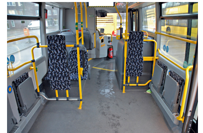
Blick auf die Stellfläche mit den Klappsitzen. Deutlich zu sehen: Die hohen Seitenwände unter den ersten Fenstern und der rechte Radkasten ohne Sitzplatz an der Vordertür. (Foto: Marc Heller)
