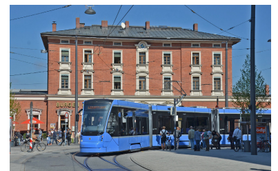
Der neueste Zug auf der neuesten Strecke: Siemens Avenio (in München als »Baureihe T« bezeichnet) vor dem Bahnhof Pasing. Seinen ersten regulären Fahrgasteinsatz erlebte das vierteilige, achttürige Fahrzeug, das bis zu 220 Passagieren Platz bietet, im September 2014. Zwei weitere Avenios sollen dies Jahr geliefert werden, insgesamt sind bisher acht bestellt. (Foto: MVG/Wolfgang Wellige)
