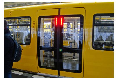
Von außen fällt die »Bombierung« des Wagenkastens vor allem an den gewölbten Türen auf. Damit sind die Wagen zehn Zentimeter breiter als die vorherigen Kleinprofil-Baureihen (2,40 Meter anstatt 2,30 Meter). (Foto: Florian Müller)
