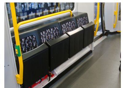
Stellfläche für Kinderwagen und Fahrräder mit Klappsitzen. Sowohl die Dicke der Lehne als auch die der Sitzflächen führen dazu, dass durch das Hochklappen kaum Platz gewonnen wird. Außerdem hätte man hier auch genug Spielraum für eine richtige Polsterung gehabt. (Foto: Florian Müller)
