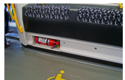
Stellfläche für Kinderwagen und Fahrräder mit Klappsitzen. Sowohl die Dicke der Lehne als auch die der Sitzflächen führen dazu, dass durch das Hochklappen kaum Platz gewonnen wird. Außerdem hätte man hier auch genug Spielraum für eine richtige Polsterung gehabt. (Foto: Florian Müller)
