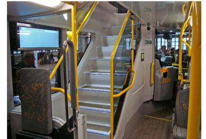
Nur eine Treppe, aber dafür etwas breiter als beim vorherigen Doppeldecker der BVG. Die Stufen sind mit blauen Lichtbändern beleuchtet. Links an der Seitenwand an der Treppe der einzige Fahrgastinfo-Monitor im Unterdeck - nur von wenigen Sitzplätzen aus sichtbar. (Foto: Florian Müller)
