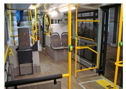
Im Mehrzweckabteil an der Mitteltür gibt es einige Klappsitze. Die Sicht nach vorne ist durch viele Einbauten, die auch von der Decke herunterhängen, eingeschränkt. Die »STOP«-Anzeige befindet sich als LED-Bauteil über dem rechten Radkasten. (Foto: Florian Müller)
