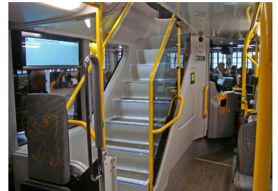
Nur eine Treppe, aber dafür etwas breiter als beim vorherigen Doppeldecker der BVG. Die Stufen sind mit blauen Lichtbändern beleuchtet. Links an der Seitenwand an der Treppe der einzige Fahrgastinfo-Monitor im Unterdeck - nur von wenigen Sitzplätzen aus sichtbar. (Foto: Florian Müller)
