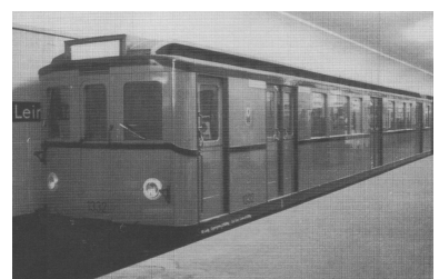
CII-Zug im U-Bahnhof Leinestraße. Züge dieses Typs und des Nachfolgetyps CIII waren technisches Vorbild für die Züge der Moskauer Metro. Ein Teil der Berliner Züge ging nach Ende des Zweiten Weltkriegs als Reparation in die Sowjetunion. (Foto: Sammlung J. Kubig)
