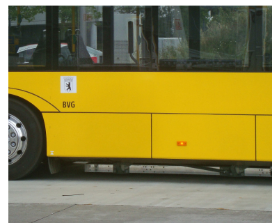
Neu ist, dass der Bus seine Batterie kontaktlos mittels induktiver Ladung auflädt. Auf dem Foto sieht man die Ladeplatte abgesenkt zum Laden unter dem Fahrzeugboden. Wichtig ist, dass der Fahrer den Bus genau über der in der Fahrbahn eingelassenen Ladetechnik parkt. Dazu sind auch mal Rangiermanöver erforderlich. (Foto: Florian Müller)
