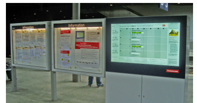
Elektronischer Wagenstandanzeiger auf dem Fernbahnsteig Richtung Süden, derzeit im Testbetrieb. (Foto: Florian Müller)
