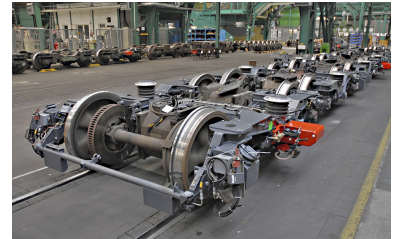
S-Bahn-Hauptwerkstatt Schöneweide. Viele Sorgen bereiten der S-Bahn die Drehgestelle der Baureihe 480, die aufwändig saniert werden müssen. (Foto: Marc Heller)
