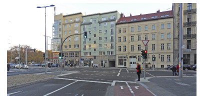
Einladung zur Rotfahrt! Die Ampel zeigt eine grüne Vollscheibe (ohne Richtungspfeile). Am rechten Mast ist daneben überraschend ein rotes Licht für Rechtsabbieger zu erkennen. Da hier nur eine Spur rechts abbiegt, könnte das Gleis bis zur Chausseestraße abmarkiert werden. (Foto: Tom Gerlich)
