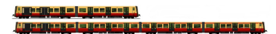
Viertelzug BR 483 und Halbzug BR 484, mit unterschiedlichen Farbvarianten. Von den Triebzügen mit zwei Wagen hat die DB 21 und von den mit vier Wagen 85 bestellt, insgesamt also 382 Wagen. Diese sollen 2020 bis 2023 ausgeliefert werden und nach und nach die Züge der Baureihen 480 und 485 ersetzen. (Zeichnung: Stadler Pankow GmbH / design: büro+staubach berlin)
