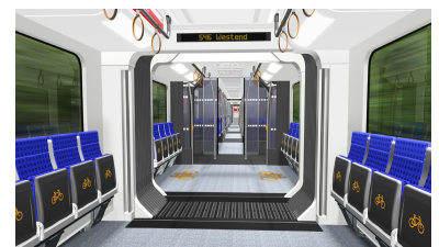
Wagenübergang mit Fahrradabteil und Klappsitzen. Mit der anschließenden Schiebetür kann ein Zugteil abriegelt werden, z. B. bei Verschmutzung eines Halbzuges. Der Wagenübergang beim 481er ist mit glatter Fläche besser gelöst als der Faltenbalg hier. (Zeichnung: Stadler Pankow GmbH / design: büro+staubach berlin)
