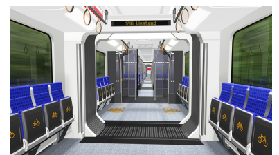
Wagenübergang mit Fahrradabteil und Klappsitzen. Mit der anschließenden Schiebetür kann ein Zugteil abgeriegelt werden, z. B. bei Verschmutzung eines Halbzuges. Der Wagenübergang beim 481er ist mit glatter Fläche besser gelöst als der Faltenbalg hier. (Zeichnung: Stadler Pankow GmbH / design: büro+staubach berlin)
