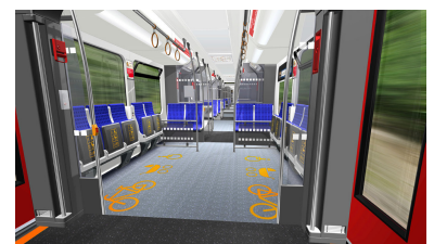
Das Mehrzweckabteil ist deutlich als solches gekennzeichnet, kann aber nur von einem Türraum mit breitem Durchgang betreten werden. Bei einer Türstörung oder großem Fahrrad- und Gepäckaufkommen kann das zur »Falle« werden. (Zeichnung: Stadler Pankow GmbH / design: büro+staubach berlin)
